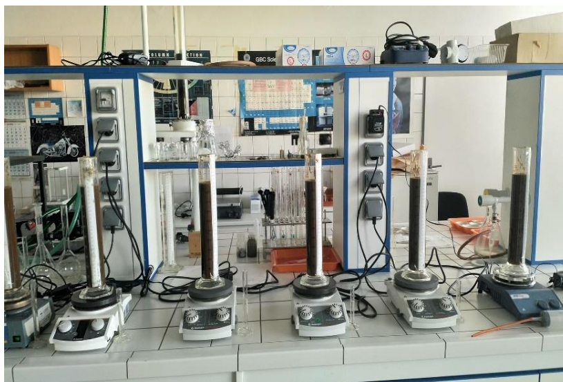
Obr. 1. Použitá aparatura pri flokulačných a sedimentačných testoch
