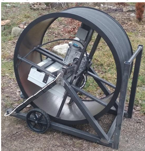
Obr. 1 Fotografie finálního uspořádání systému pro UZ čištění vrtů.
