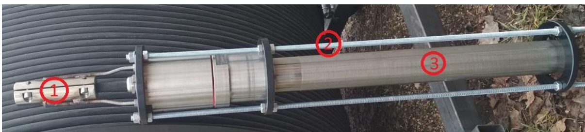
Obr. 2 Detailní finálního řešení UZ zářiče. 1 ... pevnostní spojení napájecího kabelu a tělesa zářiče; 2 ... ochranná klec aktivní části zářiče; 3 ... aktivní část zářiče.
