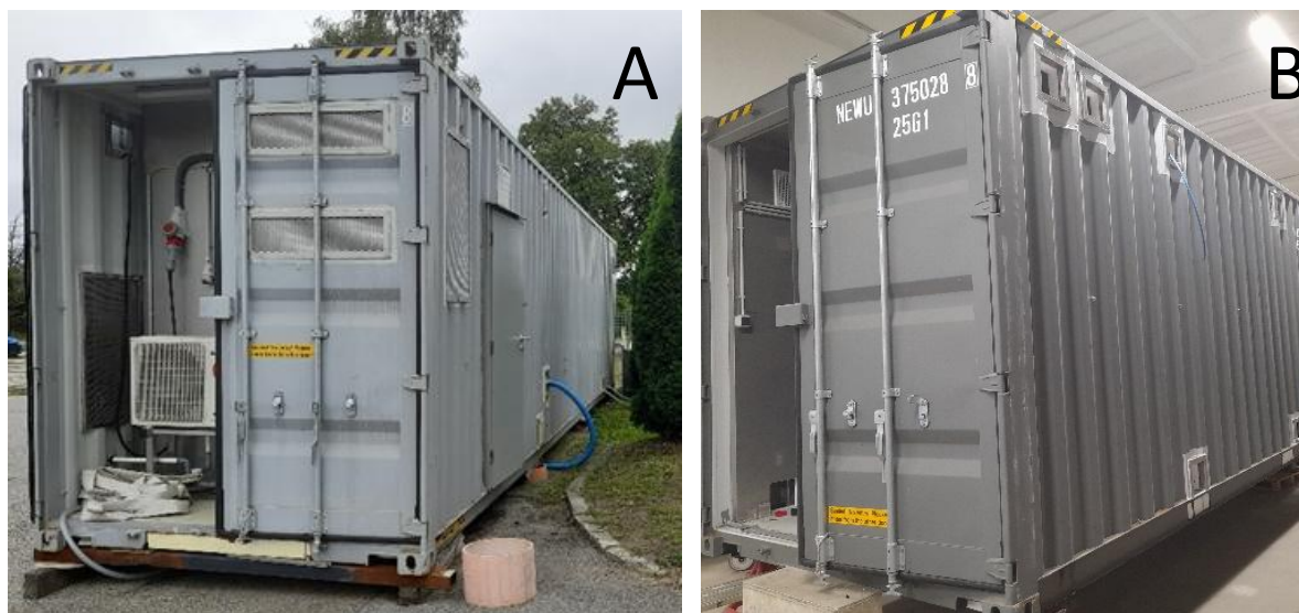
Obr. 1. a) 40' kontejner s jednotkou MBR; b) 20' kontejner s RO, MD a příslušenstvím na CEBy
